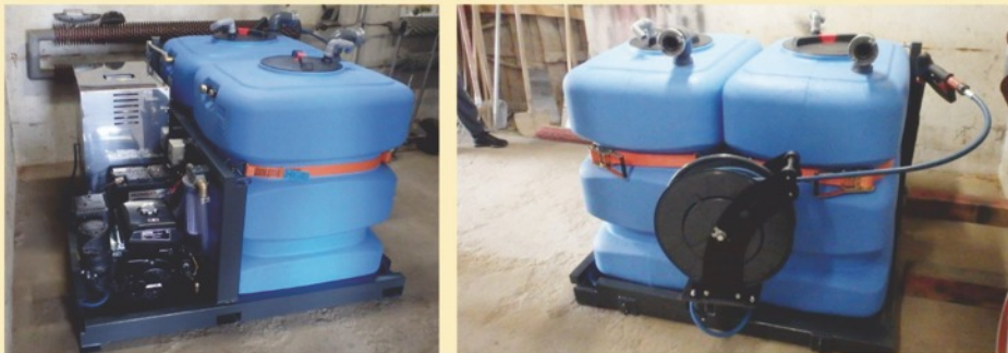
Nový stroj ECLIP pro ekologickou likvidaci plevele a pro dezinfekci
