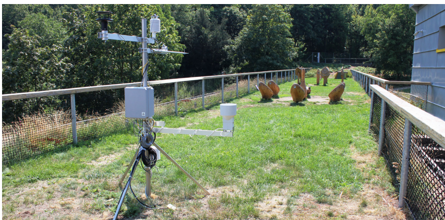
Meteostanice na zelené střeše mimo jiné měří, jak vegetace zelené střechy přispívá k vylepšování mikroklimatu města.
